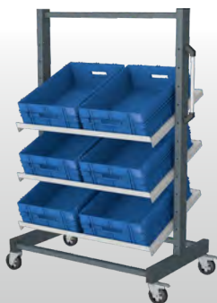
Тележка с пластиковыми ящиками 600х400х147мм (6 шт.) ШхГхВ: 1000х650х1640 мм Полки 3 шт. с установкой под 0° и 25° Ящики V=25 л. Артикул: 1620.500
