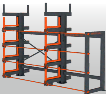
Артикул: 16104.303 для грузов до 4 м 5 полок г/п 3 тн общая г/п 15 тн
