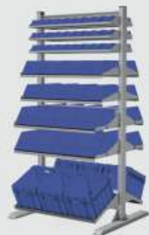
Стойка стационарная с ящиками и лотками двухсторонняя: (ШхГхВ): 1100х600х2000; 8 полок; 6 ящиков; 86 лотков; Грузоподъемность 400 кг.
